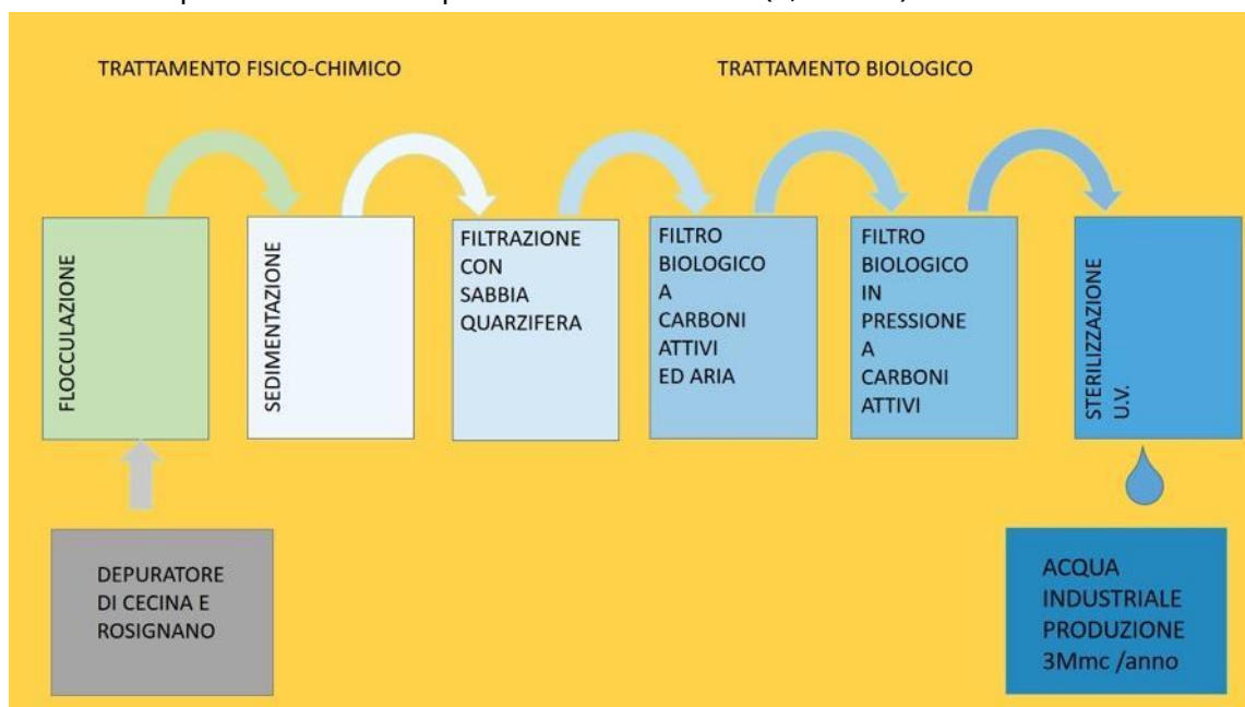
Figura 14 - Schema di funzionamento del sistema di trattamento delle acque ARETUSA. Fonte ASA spa
